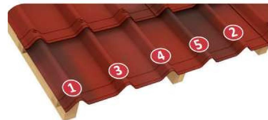
Conforme orientações do fabricante a estrutura para instalação das telhas ecológicas premium onduvilla, orientadas em inclinação de 27%, primeira fiada dos caibros, a cima e perpendiculares as vigas, de 6x6 cm, possuem uma distância de 27 cm de eixo a eixo, enquanto da segunda em diante, de 32 cm.
