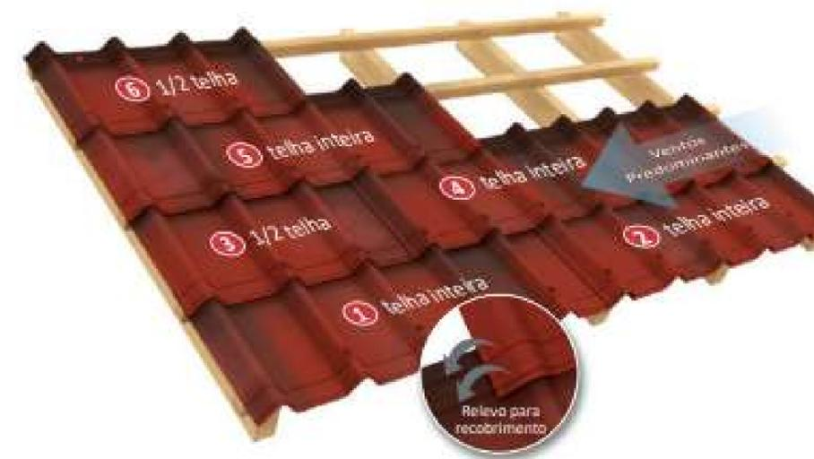
**Figura 104 - Ordem de fixação das telhas**
