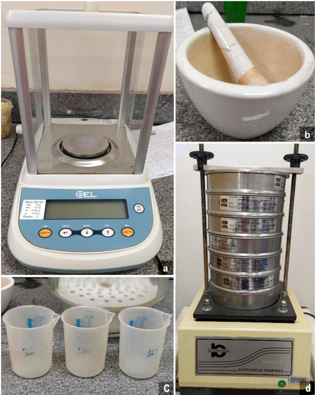
Figura 7. a. Balança para pesagem das amostras; b. Cadinho e pistilo para maceração do solo, c. Béqueres para cada tamanho de grão d. Agitador e peneiras para realização da análise granulométrica.
