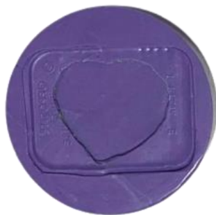
Fig. 2 Encaixe do TLD e da PSP em conjunto com a inserção da PPS de forma invertida, estabelecendo a região de deposição do PSF
