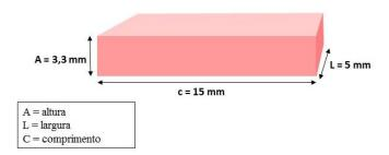
**Fig. 2:** Esquema representativo das amostras para o teste de microdureza, resistência à flexão e módulo de elasticidade
