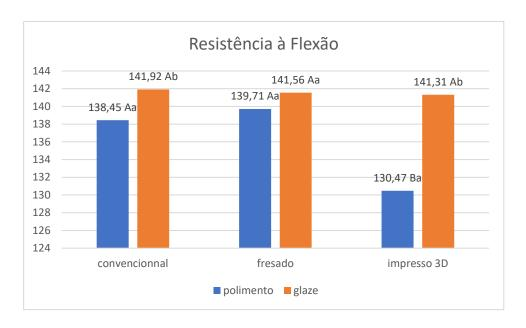
Fig. 5: Gráfico de Resistência à Flexão.
