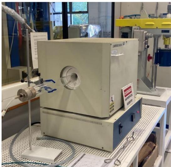
**Figura 18.** Forno tubular utilizado na pirólise da biomassa. **Fonte:** o autor.
