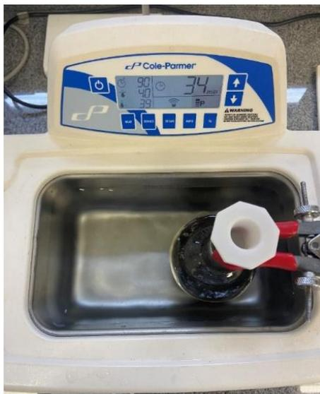
**Figura 20.** Foto da reação de magnetização em ultrassom. **Fonte:** o autor.
