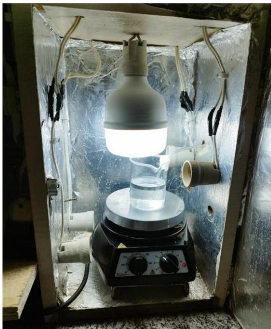
**Figura 21.** Reator fotocatalítico utilizado nos experimentos. **Fonte:** o autor.
