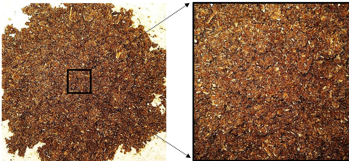
**Figura 17.** Resíduo de carcaça de tilápia após o processo de secagem e trituração. **Fonte:** o autor.
