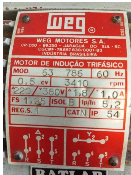
Figura 41 - Especificações técnicas do motor de indução.
