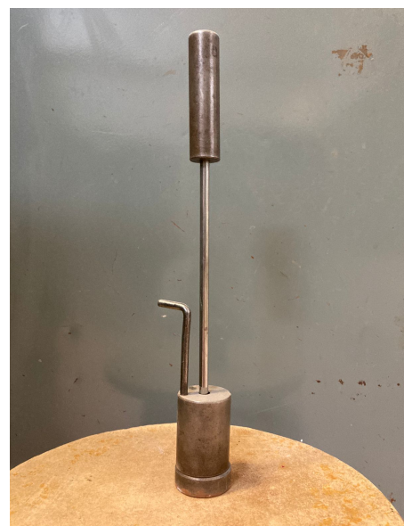
Figura 4 - Compactador metálico manual. Fonte: Autor
