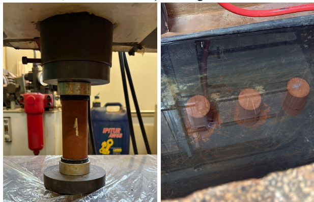
Figura 5 - Esquerda, ensaio de resistência à compressão; Direita, ensaio de absorção de água. Fonte: Autor
