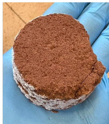
Figura 9 - Análise visual da formação de eflorescência após rompimento. Fonte: Autor
