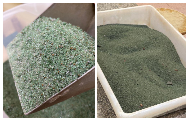
Figura 2 - Esquerda, aspecto granular da escória coletada; Direita, aspecto após a cominuição no moinho. Fonte: Autor
