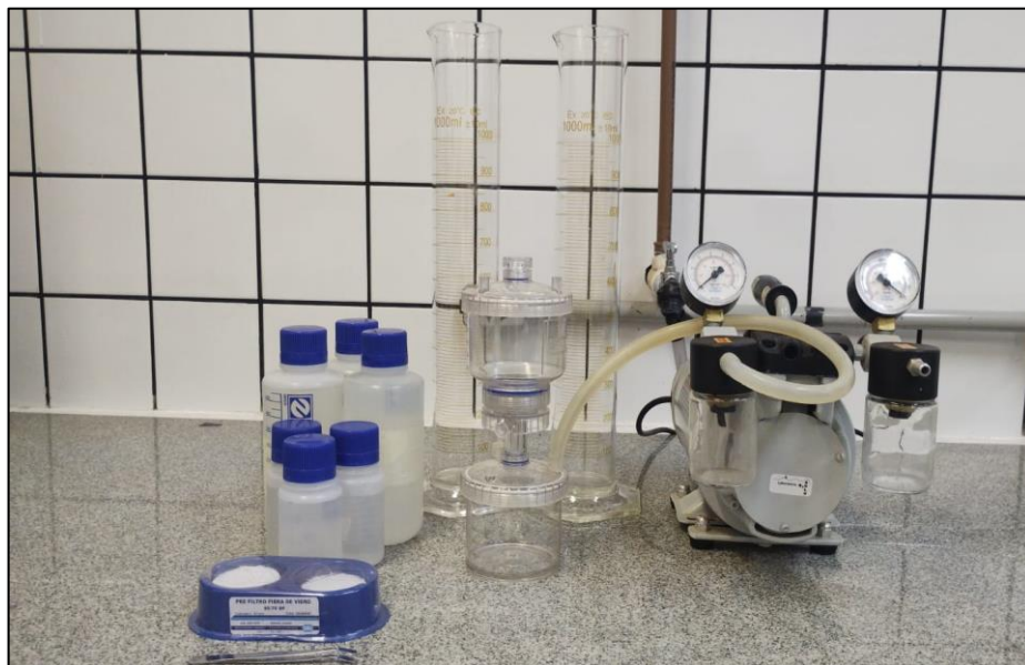
Foto 6: Conjunto de Filtração; Bomba a vácuo e unidade de filtração.
