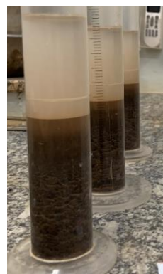
Figura 5 – Equivalente de areia: solução em repouso. Fonte: Autor
