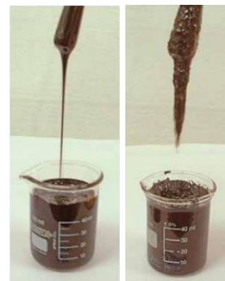
Figura 2 – Exemplo de maior consistência do asfalto-borracha no momento da usinagem: (a) Asfalto convencional; (b) Asfalto-borracha.
