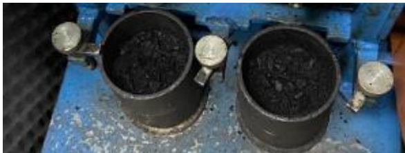
Figura 8 – Mistura asfáltica recém transferida aos moldes. Fonte: Autor
