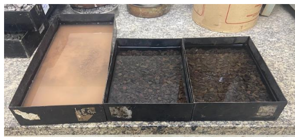
Figura 4 – Preparação do ensaio para massa específica e densidade relativa, agregado graúdo e miúdo. Fonte: Autor
