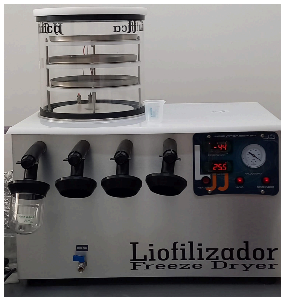
Figura 12- Equipamento liofilizador de bancada, modelo Linha LJJ, fabricante JJ Científica. Fonte: Autor, 2024.
