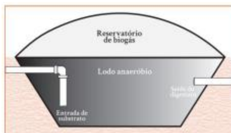
Figura 2.2.2.2 – Biodigestor de fluxo contínuo
