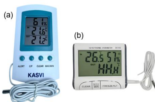
Figura 3. Termo-higrômetros utilizados para o monitoramento térmico do ambiente. Fontes: (a) DUBËSSER, 2025; (b) Máximo Lab, 2024.
