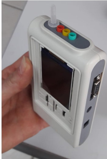
Figura 3: Monitor multiparamétrico portátil, para registro do ECG Fonte: Elomed LTDA.
