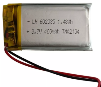
Figura 8: Bateria LiPo LH 602035 (3,7V/400mAh) Dimensões de 35 mm x20 mm x 6mm.
