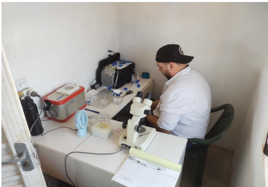
Figura 9. Laboratório montado para seleção e classificação de óocitos com os seguintes equipamentos: lupa, transportadora de óocitos, micropipeta, ponteiras, mesa aquecedora, placa de petri, tubo Falcon.
