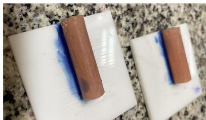
Figura 7: Bastões de resina termoplástica à base de poliamida, fixadas em base para a realização do corte e confecção dos corpos de prova deste material.
