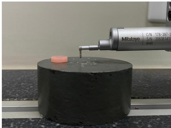
Figura 13: Ponta do rugosímetro e corpo de prova.
