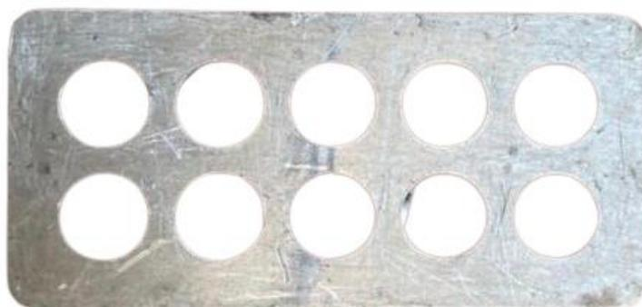
Figura 2: Molde metálico usado na mufla para confeccionar os corpos de prova em resina acrílica.
