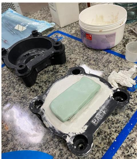
Figura 1: Preparo das muflas para confecção dos corpos de prova em resina acrílica.
