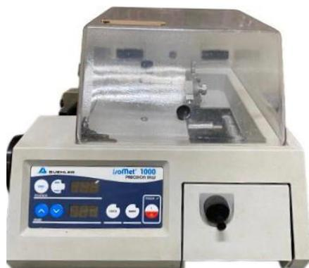
Figura 8: Cortadora de precisão Isomet 1000, Buhler.
