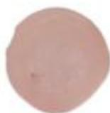
Figura 11: Corpo de prova de resina acrílica termoplástica à base de poliamida após polimento.
