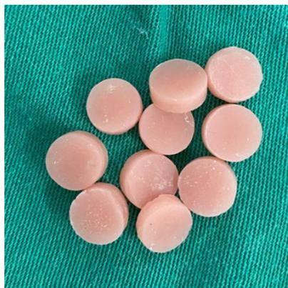
Figura 4: Corpos de prova de resina acrílica termopolimerizável.
