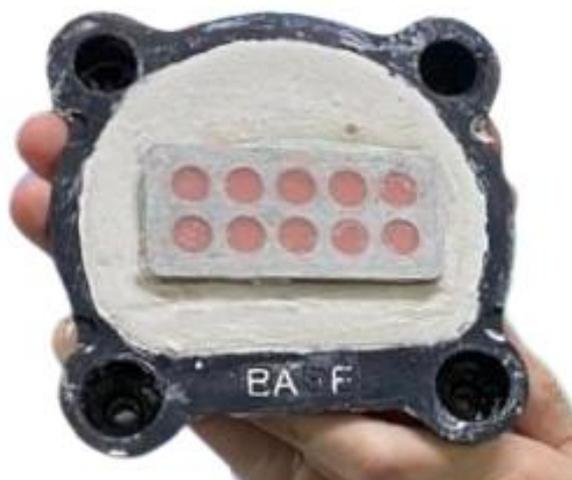
Figura 3: Mufla preparada com os corpos de prova prontos após a termoativação em microondas.
