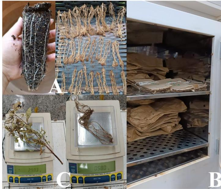
**Figura 4.** Processos realizados para avaliação das mudas. (A) Lavagem das raízes, realizada para remover o substrato e preparar as plantas para o processo de secagem. (B) Estufa para secagem, utilizada para remover a umidade das mudas, preparando-as para a pesagem e análise. (C) Obtenção da massa seca da parte aérea e do sistema radicular, realizada após a secagem das plantas, para avaliar o crescimento e o desenvolvimento das mudas. Fonte: Elaborada pela autora (2023).
