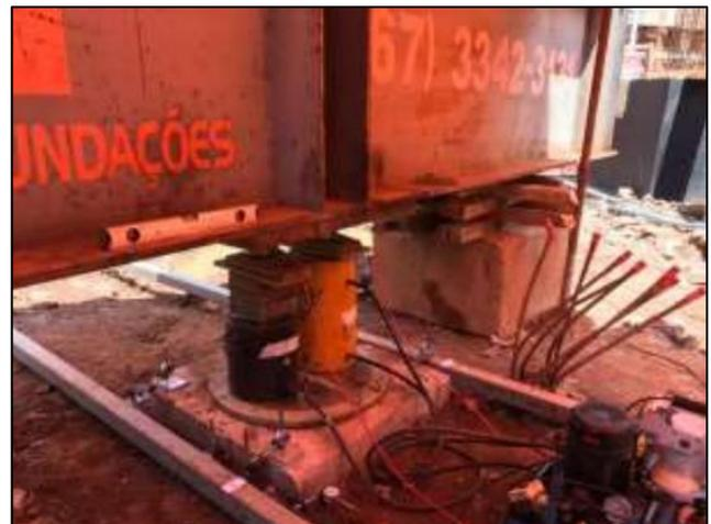
Figura 17 – Croqui de montagem da prova de carga. Fonte: Luzzardi, 2015.
