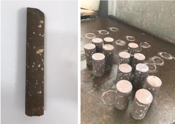
Conforme apresentado na Figura 14, os corpos de rocha coletados a partir da sondagem rotativa, foram limpos e retificados para o ensaio de compressão uniaxial não confinado. As imagens do ensaio são apresentadas na Figura 15.
