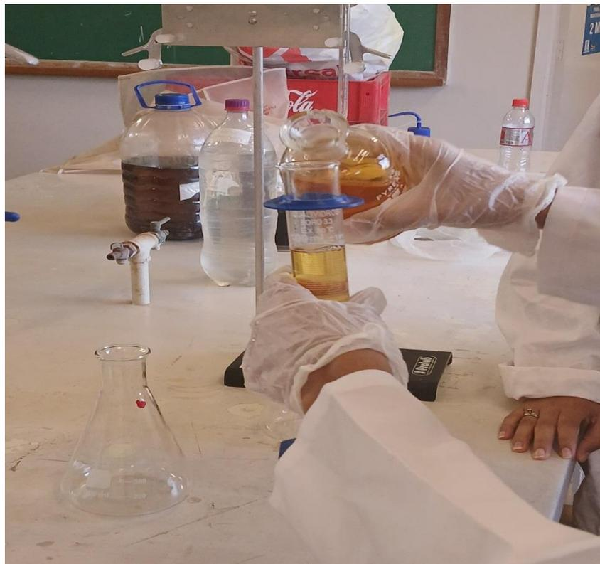
Imagem 06- Procedimento de Winkler para obtenção do resultado de oxigênio dissolvido (mg/L).
