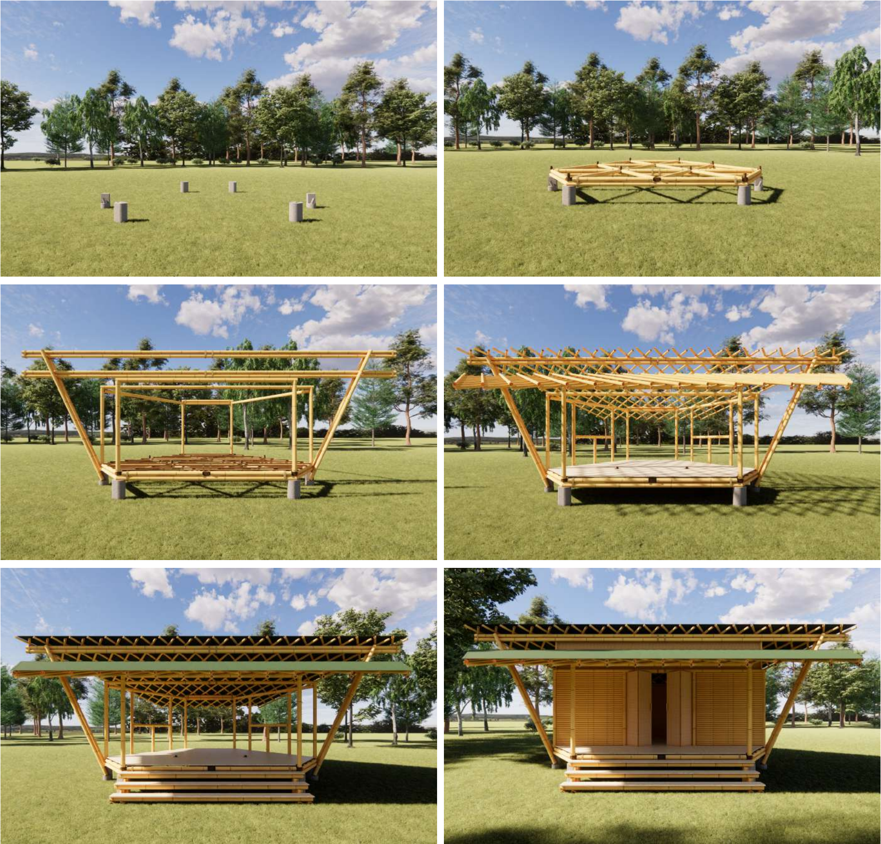
Figuras 58 a 63 - Sequência explicativa da montagem do abrigo.
