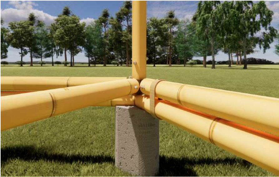
Figuras 74 a 78 - Conexões nas bases de concreto.
