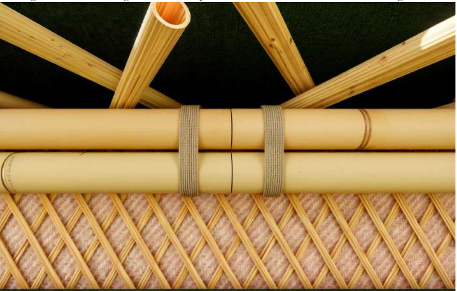
Figuras 79 a 83 - Vigas centrais superiores e conexões na estrutura triangulada.
