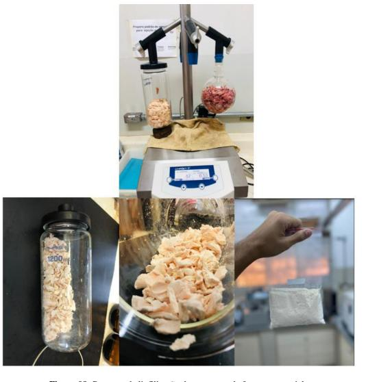
Figura 09- Processo de liofilização das amostras de frango comercial.
