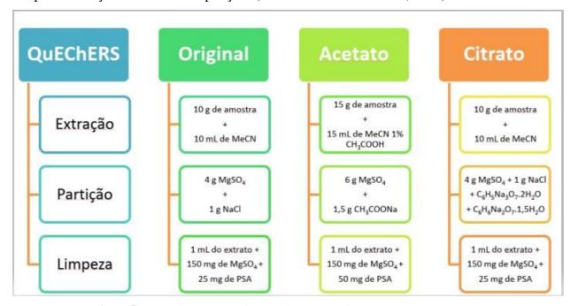
Figura 5 – Procedimento Experimental da extração via QuEChERS. (ARIAS, et al., 2019).
