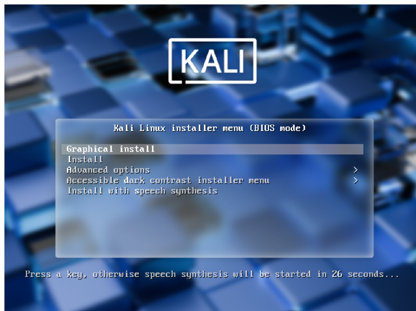
Figura 4.5: Tela inicial do instalador Kali Linux: seleção da opção Graphical install .
