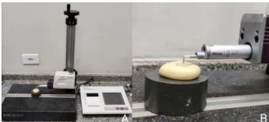
Fig. 10: A. Rugosímetro Compacto SJ-410 ® - Mitutoyo Corporation. B. Corpo de prova estabilizado em base de silicone de adição.
