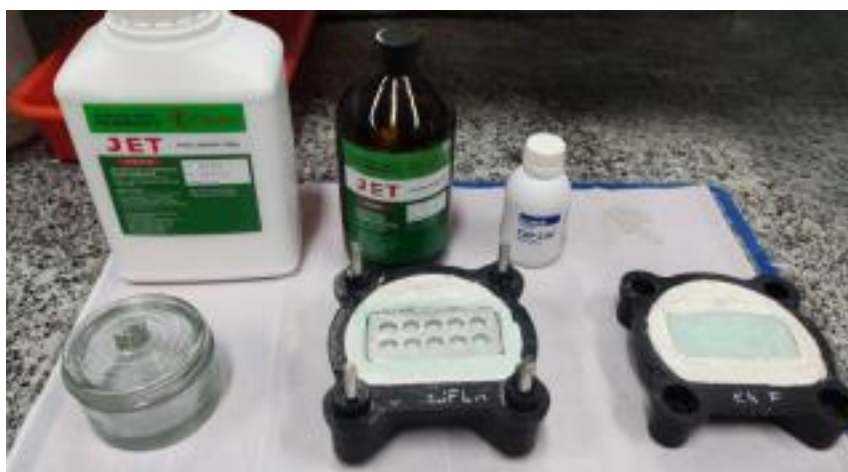
Fig. 2: Confeção dos corpos de prova de resina acrílica autopolimerizável.
