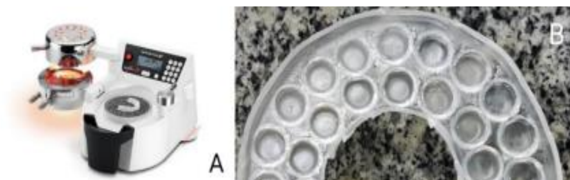
Fig. 5: A. Máquina Ministar S- Scheu Dental®. B. Confeção das amostras de resina mistas.
