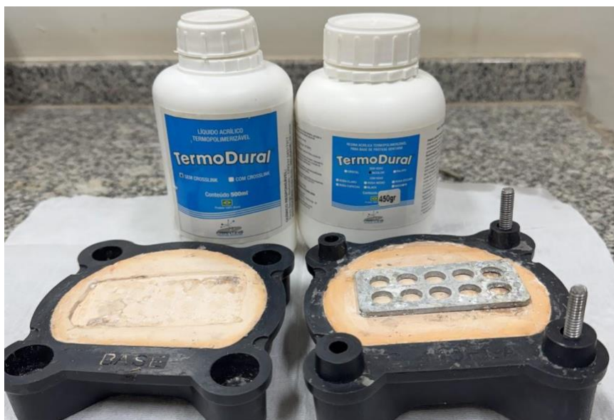
Fig. 3: Confeção dos corpos de prova de resina acrílica termopolimerizável.
