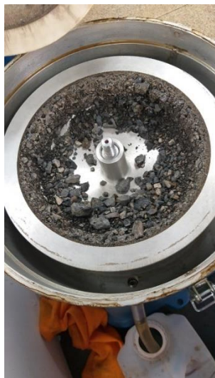
Figura 8 – Etapa final de extração através do Rotarex.
