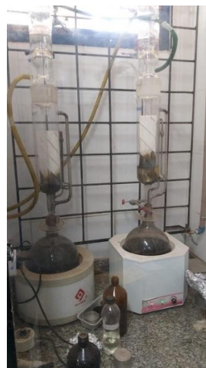
Figura 2 – Equipamento Soxhlet com a amostra durante o processo de extração do ligante asfáltico. Fonte: Autor
