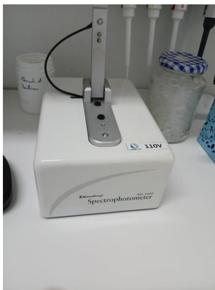
Figura 77: Espectrofotômetro para quantificação de DNA ou RNA extraído
