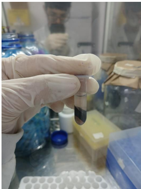
Figura 76: três fases após separação na centrifugação.
