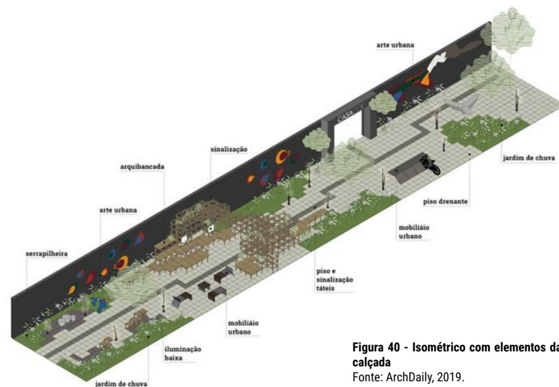
**Figura 40 - Isométrico com elementos da calçada**
