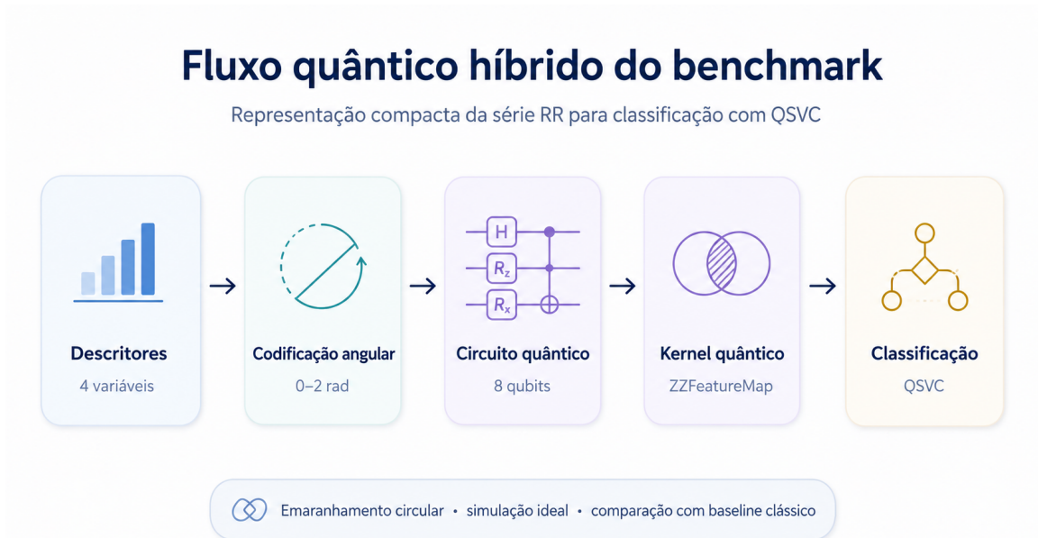
Figura 3.6: Fluxo metodológico do modelo quântico híbrido. Os descritores clássicos são selecionados, escalonados, codificados como ângulos, processados por um Quantum Feature Map e convertidos em uma matriz de kernel utilizada por um SVM clássico.
