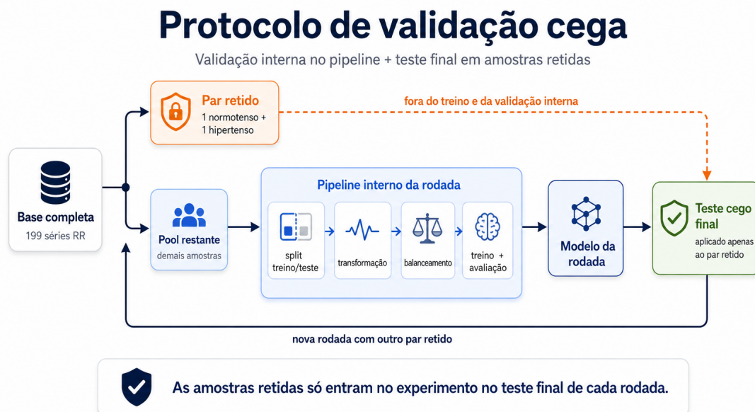
Figura 3.7: Esquema da validação cega por amostras retidas. Uma amostra normotensa e uma amostra da classe hipertensa são removidas antes dos ajustes aprendidos; o treinamento ocorre sem acesso a essas amostras, que são avaliadas apenas ao final como observações inéditas.
