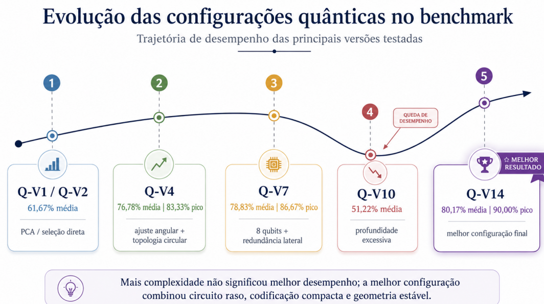
Figura 4.2: Evolução dos principais marcos quânticos híbridos avaliados ao longo do desenvolvimento experimental. A queda observada no marco Q-V10 ilustra que maior profundidade de circuito não implicou melhor separabilidade para as séries RR analisadas.
