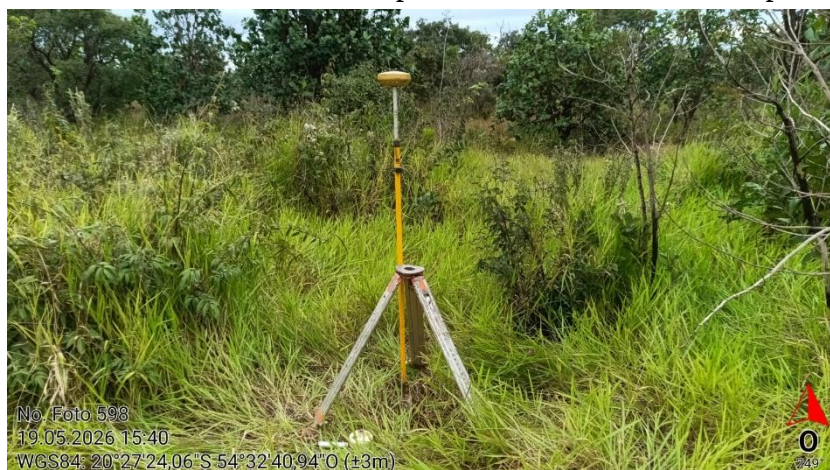
Foto 7: Marco Base local de referência implantado com auxílio de receptor GNSS L1/L2
