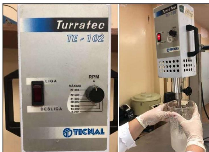
Figura 1 – Aparelho homogeneizador/triturador e processo de homogeneização de óleo de peixe rico em ômega-3 com lecitina de soja como emulsificante na presença de ácido acético a 1%
