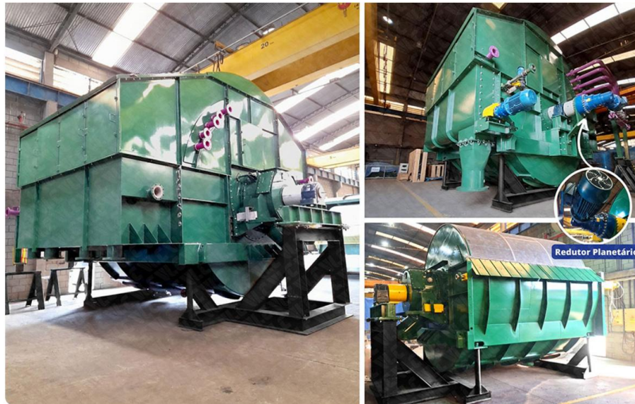
Figura 31: Filtro de Tambor Rotativo a Vácuo Engrossador/Lavador da VLC.
