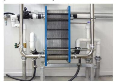
Figura 5. TCP utilizado no processo de resfriamento do leite
