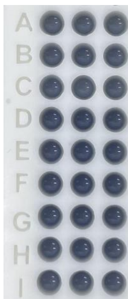
Figura 16 –Imagem do dispositivo utilizada na avaliação da estabilidade do produto colorido formado na reação entre o 5-hidroxitriptofano (5-HTP) e o reagente de Folin–Ciocalteu. Micropoços contendo o produto da reação após (A) 20 min e armazenados por diferentes períodos: (B) 1; (C) 2; (D) 3; (E) 4; (F) 7; (G) 10; (H) 14 e (I) 17 dias.
