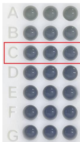
Figura 8 – Imagem do dispositivo contendo as misturas reacionais após diferentes tempos de reação: A (3 min), B (10 min), C (20 min), D (30 min), E (40 min), F (50 min) e G (60 min).
