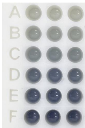
Figura 23 - Imagem dos micropoços com diferentes concentrações de 5-hidroxitriptofano: 0,0 \text{mg}\cdot\text{L}^{-1} (branco, representado pela linha A), 1,5; 3,0; 5,0; 6,0; 9,0 e 12,0 \text{mg}\cdot\text{L}^{-1} (linhas B a G, respectivamente)
