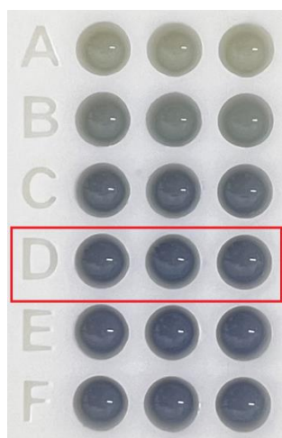
Figura 12 –Imagem do dispositivo com diferentes concentrações finais de carbonato de sódio no micropoço: 0,0; 0,5; 1,0; 1,5; 2,0 e 2,5% (m/v), correspondentes às linhas A a F, respectivamente.
