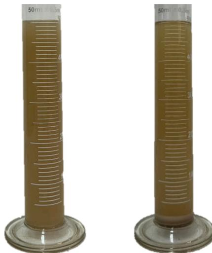
Figura 1 – Efluente bruto do processo de Parboilização, sem e com sedimentação de 60 min, respectivamente.
