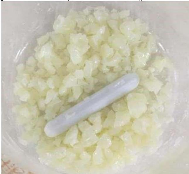
O sólido foi triturado e repartido para seguir para a calcinação em três temperaturas diferentes: 400 °C, 650°C e 900 °C durante 4 horas, com pausa depois de 2 horas para triturar, a fim de não permitir que as partículas coalesçam. Os semicondutores foram triturados em cadinho de porcelana e tamisados até obtenção em grânulos de no mínimo 100 *mesh* com instrumentos de tamisação. Os pós
