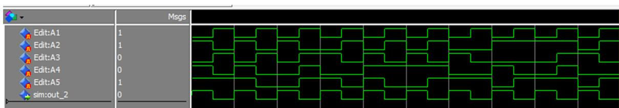
Figura 5 – Simulação do PDL no Modelsim. Este componente age como uma porta NOT para a entrada A1.
