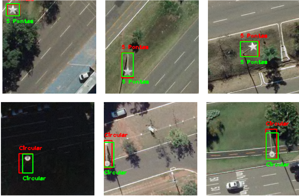
Figura 22 – Postes 5 Pontas e Circular detectados pelo método TOOD. As caixas delimitadoras vermelhas representam o ground-truth enquanto a caixa verde representa a detecção do método.
