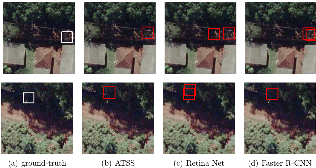
Figura 6 – Exemplos de imagens com postes sombreados: (a) ground-truth ; (b) ATSS; (c) RetinaNet; e (d) Faster R-CNN.
