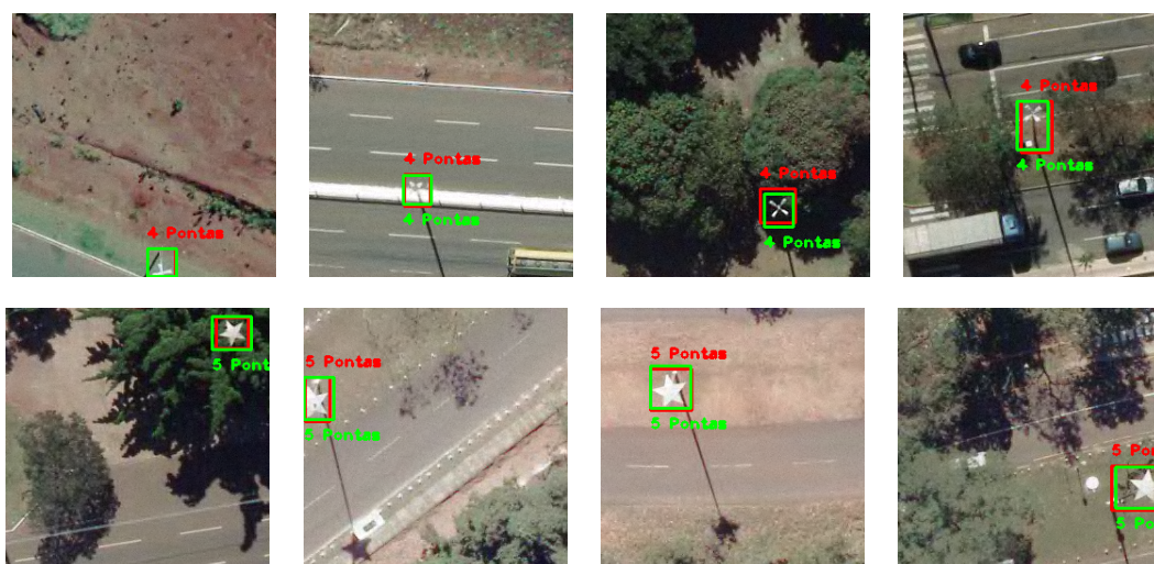
Figura 21 – Postes 4 e 5 Pontas detectados pelo método Deformable-DETR. As caixas delimitadoras vermelhas representam o ground-truth enquanto a caixa verde representa a detecção do método.
