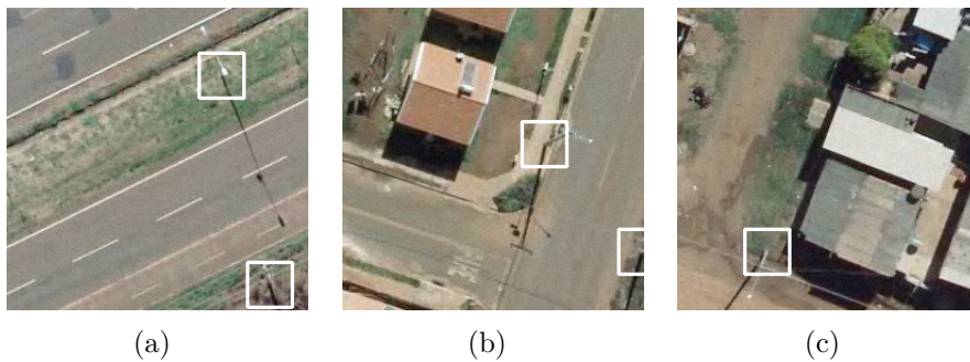
Figura 9 – Exemplos de postes que não são totalmente cobertos por uma caixa delimitadora com 40 \times 40 de tamanho: (a) Exemplo 1; (b) Exemplo 2; e (c) Exemplo 3.
