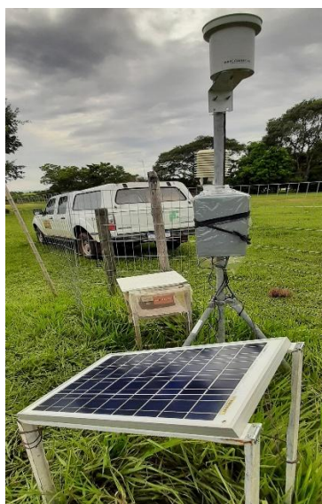
Figura 13 – EMA-Arduino – Fazenda Querência – Alto curso da Bacia Hidrográfica do Córrego Moeda
