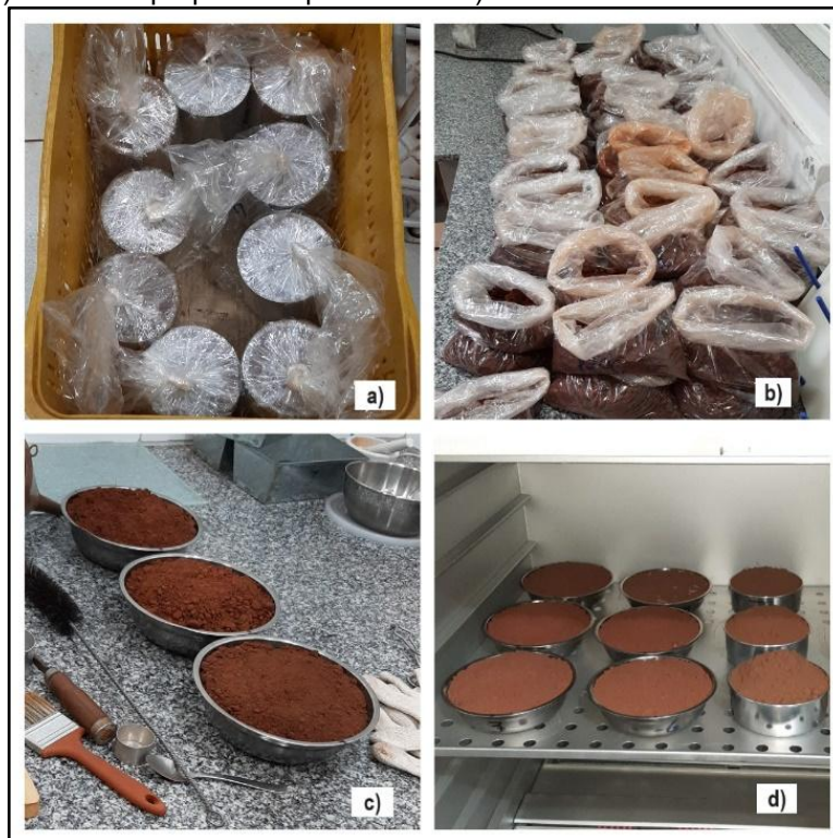
Figura 11 – a) Amostras embaladas para transporte. b) Amostras deformadas (retiradas dos cilindros) c) Amostras preparadas para estufa d) Amostras na estufa do LAPA
