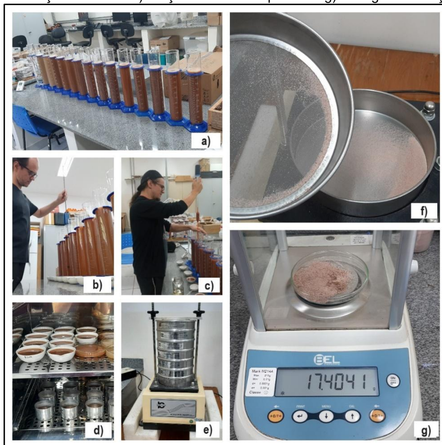
Figura 16 – a) Provetas de sedimentação preparadas. b) Agitação da suspensão. c) Pipetagem de amostra de argila. d) Secagem das amostras de argila em estufa. e) Agitador de Peneiras usado para separação das frações de areia. f) Frações de areia separadas. g) Pesagem da fração de areia.
