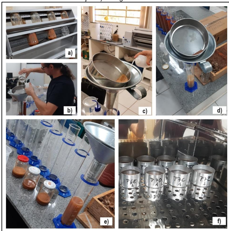
Figura 15 – a) Amostras no agitador tipo Wagner. b) Retirada da amostra dos frascos para peneira. c) Lavagem da areia para separação da argila e do silte. d) Areia separada. e) Preparação de proveta de sedimentação. f) Secagem da areia em estufa
