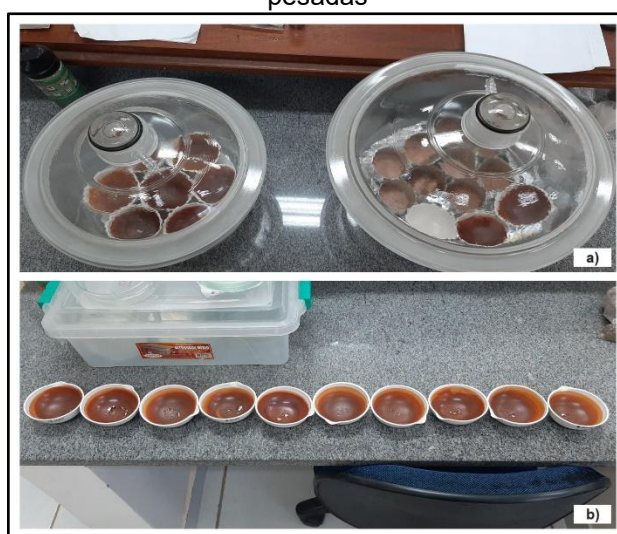
Figura 17 – a) Amostras esfriando em dessecador. b) Amostras de argila depois de secas, frias e pesadas
