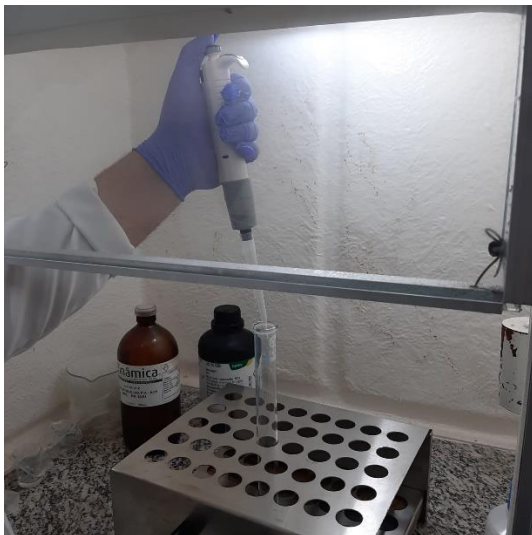
Figura 3 - Adição de ácido nítrico ( \text{HNO}_3 ) e peróxido de hidrogênio ( \text{H}_2\text{O}_2 ) nas amostras.
