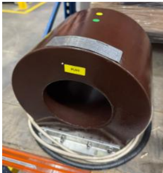
Figura 10- Transformador de Corrente (TC)
