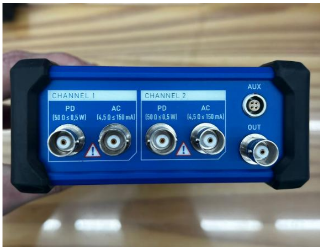
Figura 19- MPD 800 Vista Lateral Para Realizar Conexão Com Capacitor De Acoplamento
