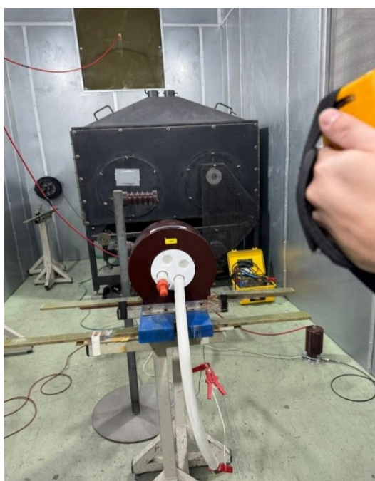
Figura 27: Montagem dos elementos para ensaio de DP (TC, Bucha EPS, Cabos, Capacitor de Acoplamento, HV FILTER 150/5, Garras de conexão de alimentação e aterramento)
