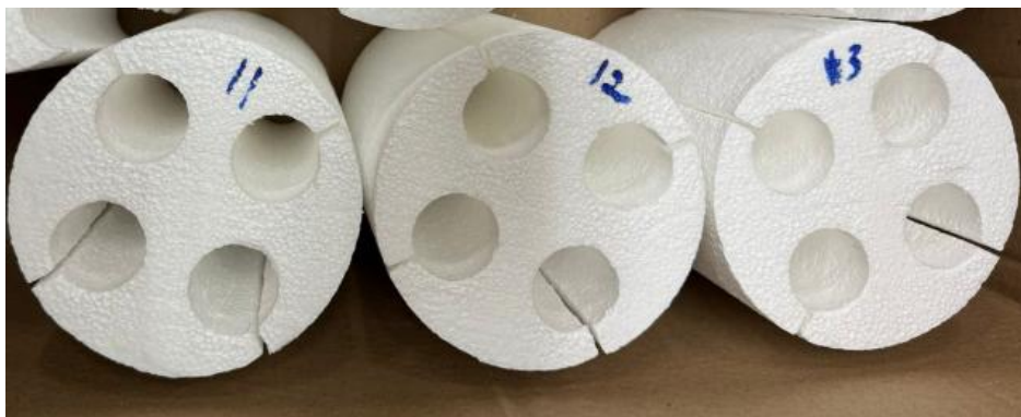
Figura 26- Protótipo da Bucha de espaçamento no Material EPS.
