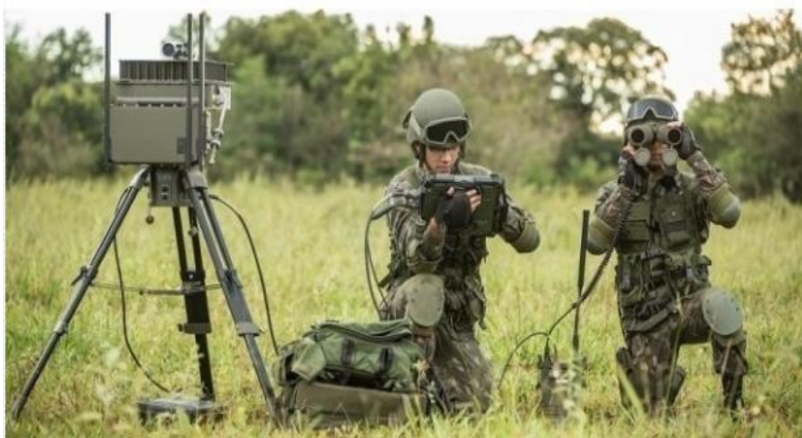
Figura 7 – Radar M.20 Terrestre
