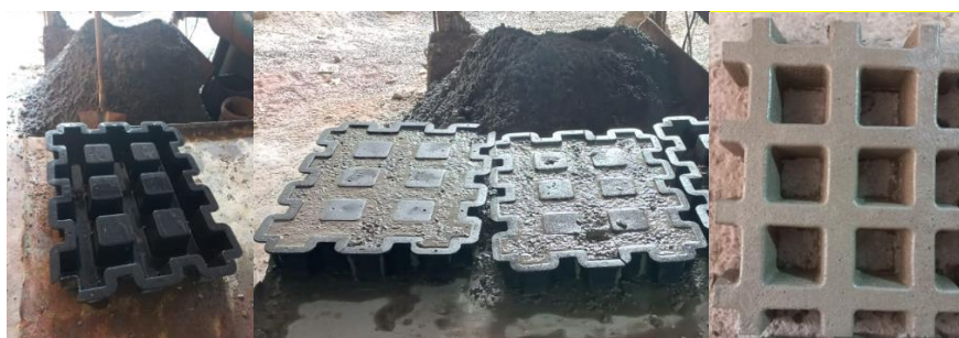
Figura 6 –Retirada da forma
