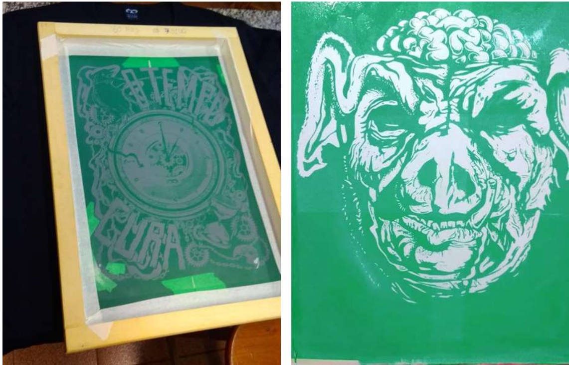
Figura 35 - Fotolitos já impressos na matriz
