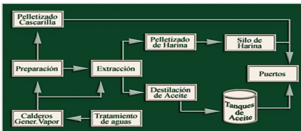
Figura nº 5 - Processo Produtivo da soja da Gravetal Bolívia S/A. ( Fonte: Gravetal Bolívia S/A, 2005).
