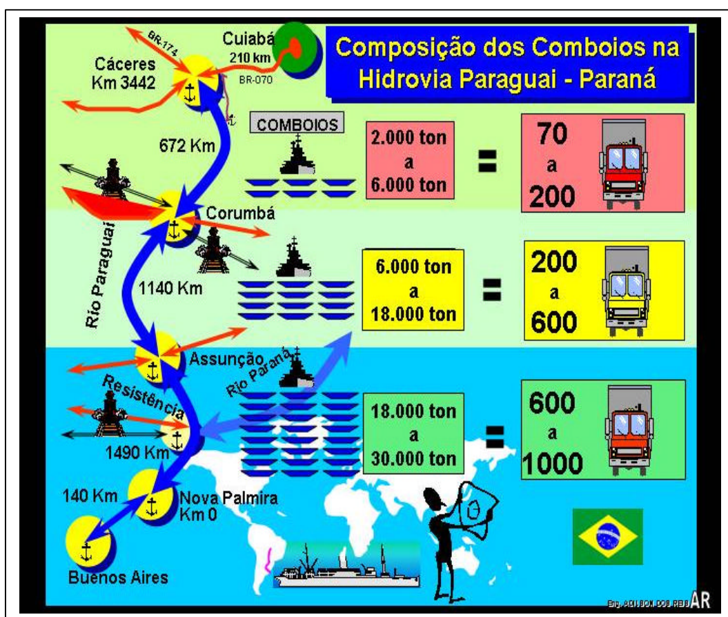
Figura 3: Composição dos comboios na hidrovia Paraguai Paraná e comparação com a capacidade do transporte rodoviário. (Fonte: Ahipar, 2004)
