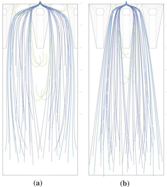
Figura 12: Diagrama dos padrões de circulação onde (b) tem uma distância menor que (a) e a performance hidráulica de (b) é melhor do que de (a). Adaptado de BALDERAS GUZMÁN; NEPF; BERGER, (2018).
