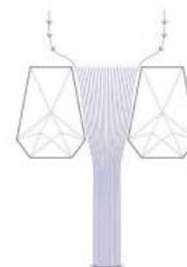
Figura 15: (a) performa melhor do que (a) invertido porque a forma da linha de fluxo otimiza a propagação do jato. Adaptado de BALDERAS GUZMÁN; NEPF; BERGER, (2018).
