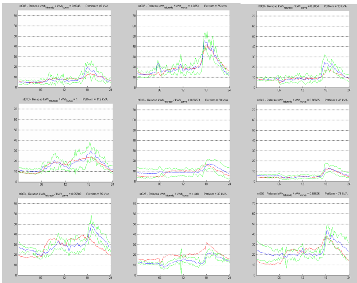
Figura 4.20 - Curvas estimada versus medida em 09 transformadores da amostra para k=40.
