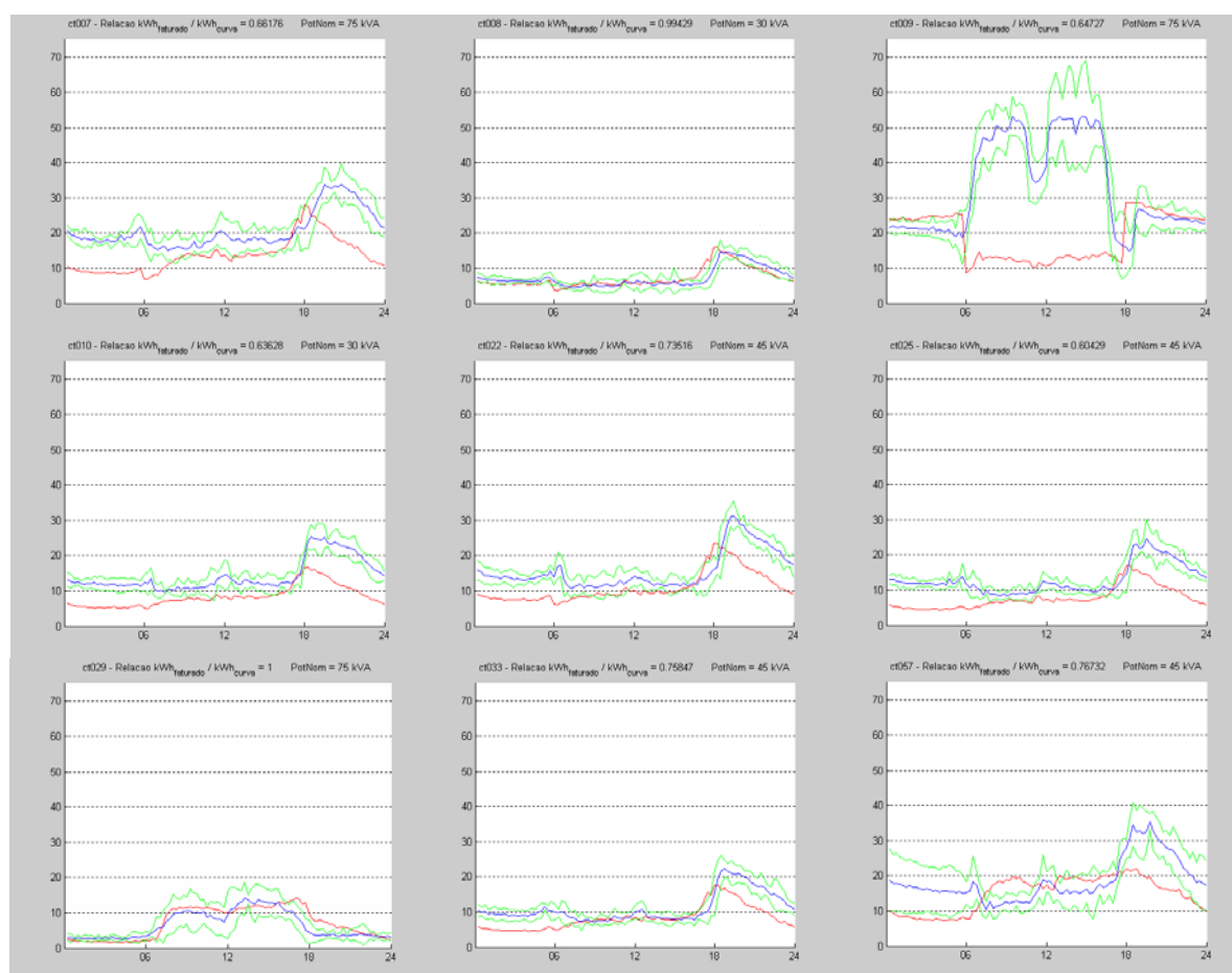
Figura 4.19 - Curvas estimada versus medida em 09 transformadores da amostra para k=40.
