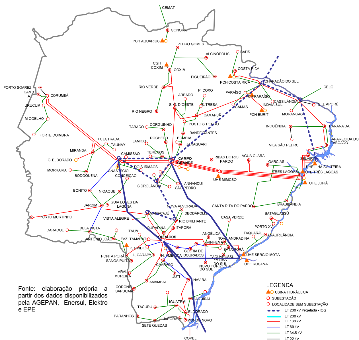
Figura 4.1 – Visualização do sistema de geração, distribuição, de transmissão no Estado de Mato Grosso do Sul.
