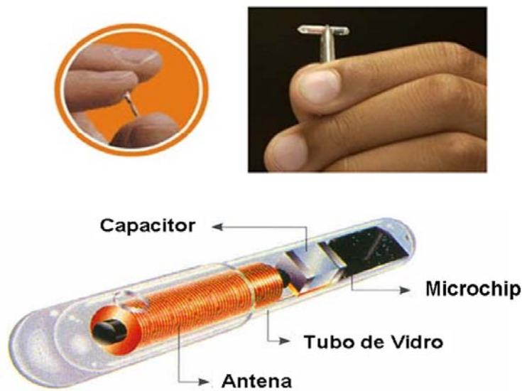
Figura 2.2: Esquema de um transponder .
