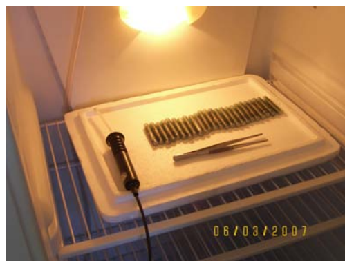
Figura 5.4: Pinça dente de rato, termômetro digital e transponders dentro da estufa B.O.D.
