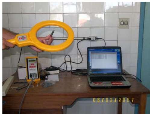
Figura 5.1: Leitura dos transponders TXMU00.
