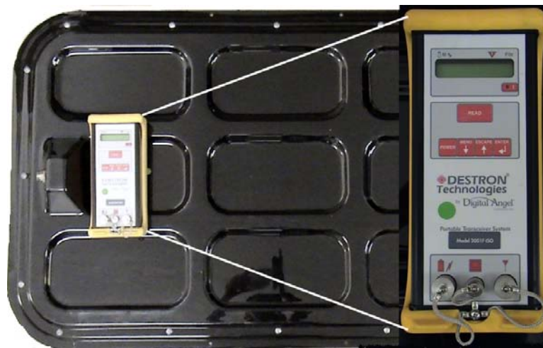
Figura 3.2: Antena e leitora FS2001-ISO utilizada neste trabalho.
