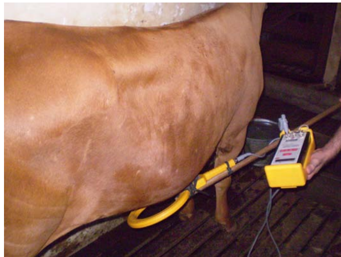
Figura 5.6: Aferição da temperatura do transponder na prega umbilical.
