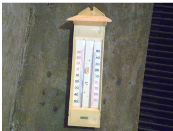
Figura 5.8: Aferição da temperatura do ambiente com termômetro de máximo e mínimo.
