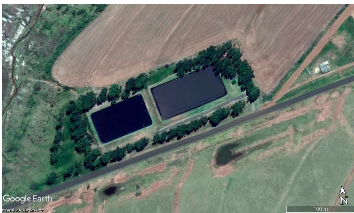
Imagem - ETE 2D Lagoa Facultativa + Lagoa de Maturação, Vazão de projeto = 20 \text{ L.s}^{-1} .
