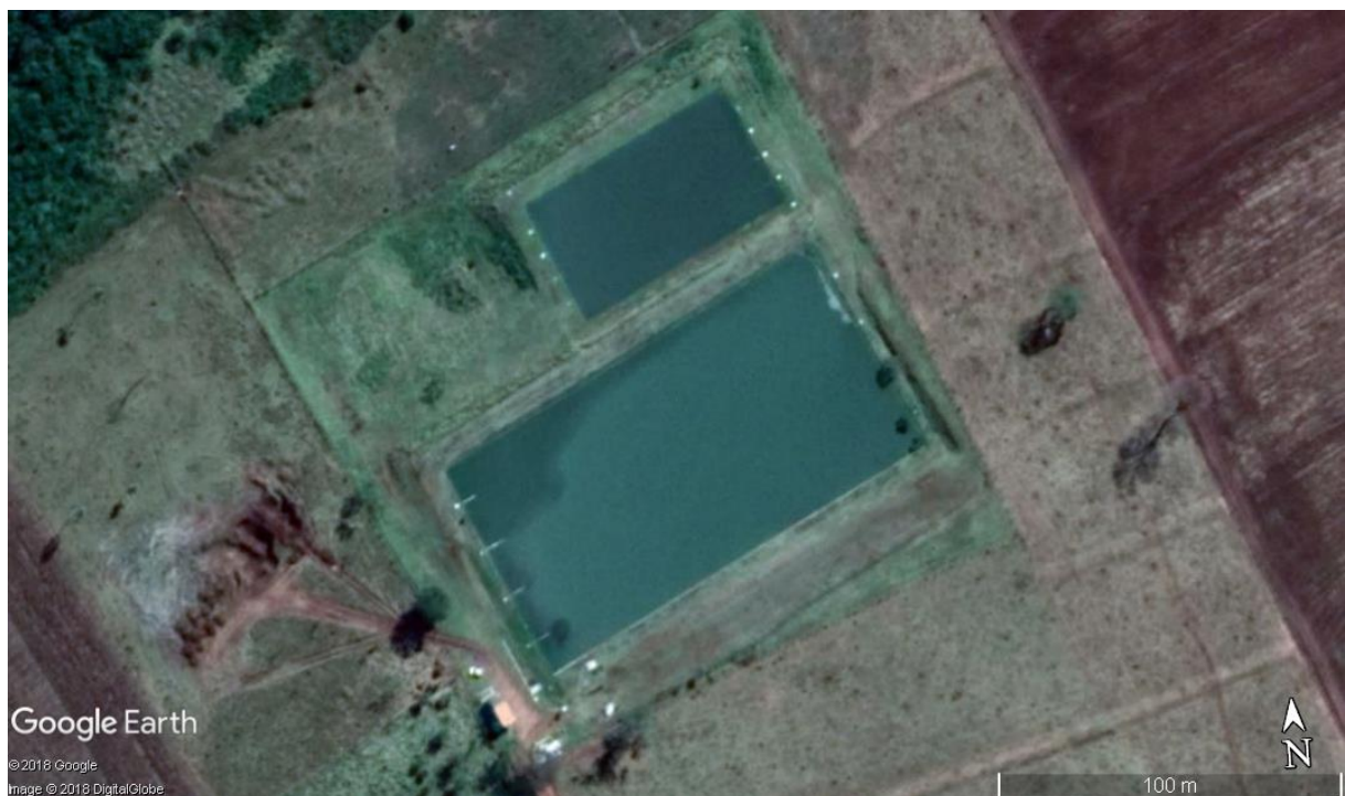
Imagem - ETE 2B Lagoa Facultativa + Lagoa de Maturação, vazão de projeto = 6 \text{ L.s}^{-1} .
