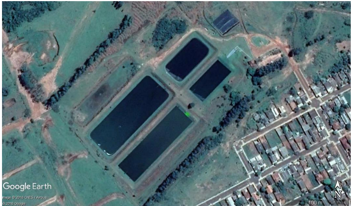
Imagem - ETE 1A Lagoa Anaeróbia + Lagoa Facultativa, vazão de projeto = 90 \text{ L.s}^{-1} .
