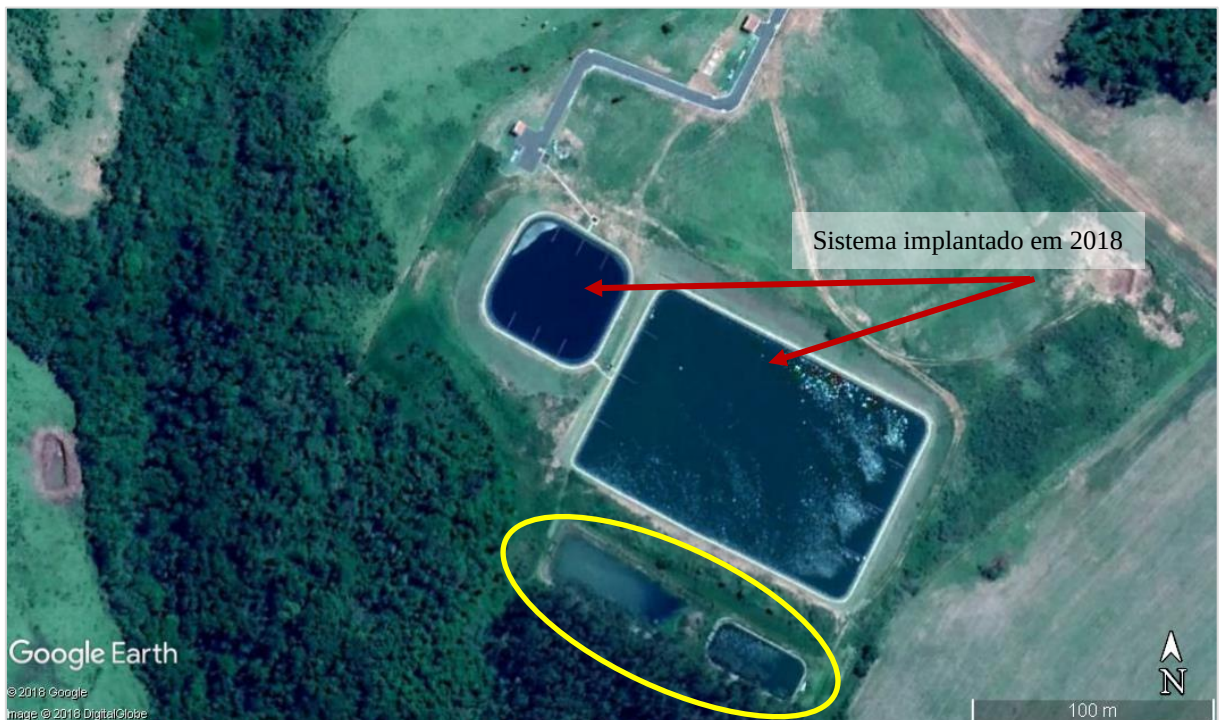
Imagem - ETE 1B- Lagoa Anaeróbia + Lagoa Facultativa, vazão de projeto = 5 \text{ L.s}^{-1} .
