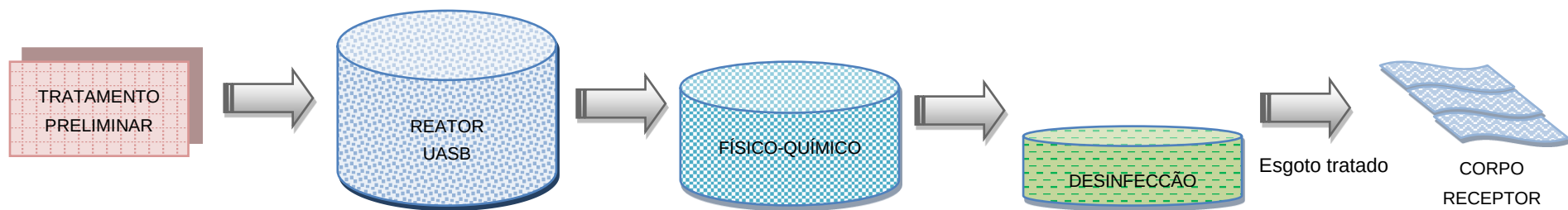
80 Figura 4.9. Fluxograma da Tecnologia 7: Tratamento Preliminar + Reator UASB + Físico-químico + Desinfecção.
