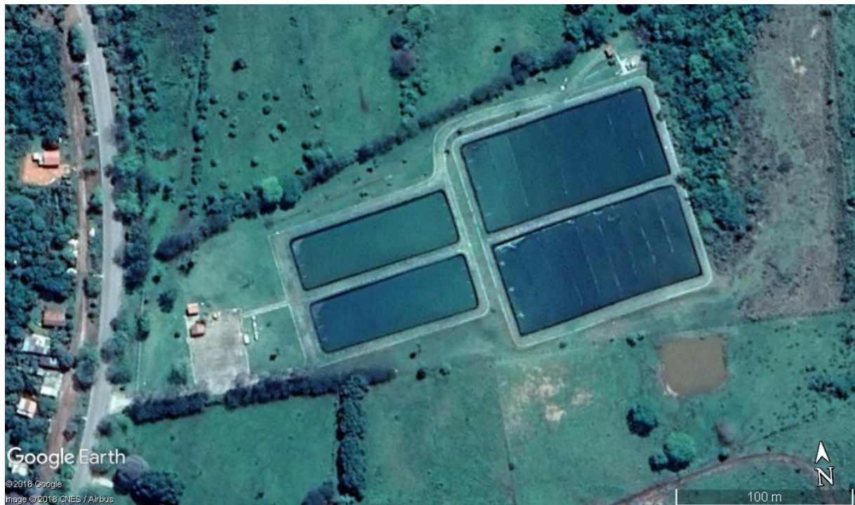
Imagem - ETE 2A Lagoa Facultativa + Lagoa de Maturação, vazão de projeto = 20 \text{ L.s}^{-1} .
