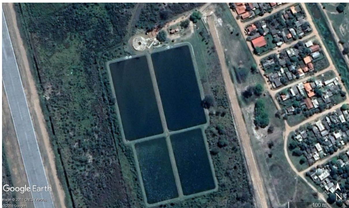
Imagem - ETE 2C Lagoa Facultativa + Lagoa de Maturação, vazão de projeto = 36 \text{ L.s}^{-1} .
