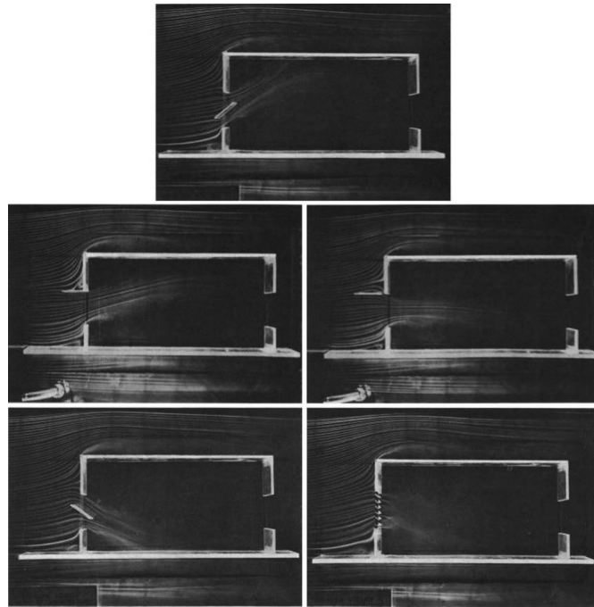
Figura 4.18. Dispositivos em aberturas
