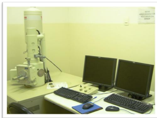
Figura 13- MEV modelo-Jeol JSM 6380LV
