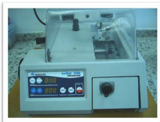
Figura 05- Máquina de corte Isomet 1000, Buelher
