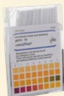
Figura 7: Fita de pH. Fonte: Png EGG
